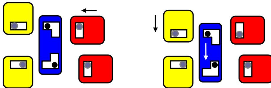
Erst wenn beide Eingänge auf die 1-Position gebracht werden, bewegt sich mit dem Takt auch das Ausgangsblech in die 1-Position. Das zeigen die folgenden Explosionsbilder.
