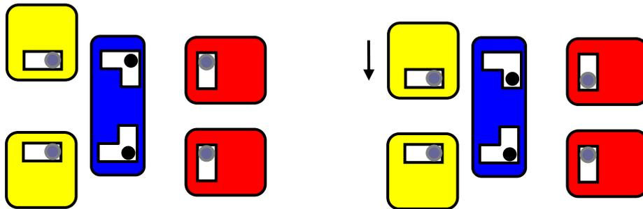
Jetzt werden alle Bleche wieder zurück in die Ausgangslage gebracht. dann wird das Blech des oberen Eingangs nach links in die 1-Position geschoben. Es entsteht das linke der folgenden Bilder. Nach Betätigen des Takts (rechtes Bild) hat sich zwar das Kopplungsblech, nicht aber das Ausgangsblech bewegt.
