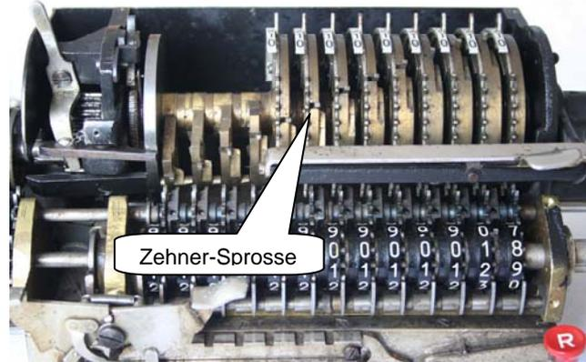
Anschließend folgt je Rad eine Zehnersprosse für den Übertrag. Diese Zehnersprossen sind von Rad zu Rad leicht gegeneinander verschoben, so dass die Überträge allesamt kurz hintereinander erfolgen können. Dafür wird ein weiteres Drittel des Sprossenradumfangs gebraucht.
