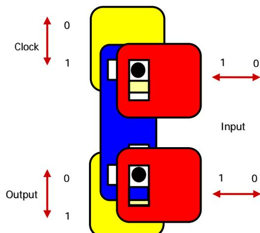
AND-Schaltglied (logisches Und): Gelb sind das Taktblech und das Blech der Ausgangsgröße. Die beiden Bleche für die Eingangsgrößen sind rot und blau ist das Kopplungsblech. Die schwarzen Kreise repräsentieren die Schaltstifte in Draufsicht. Sie stellen Kopplungen zwischen den Blechen her.
