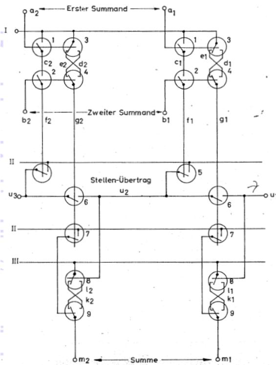
Räumliche Anordnung der mechanischen Schaltglieder des Addierwerkes entspr. Fig.7 (Gerät Z1)
