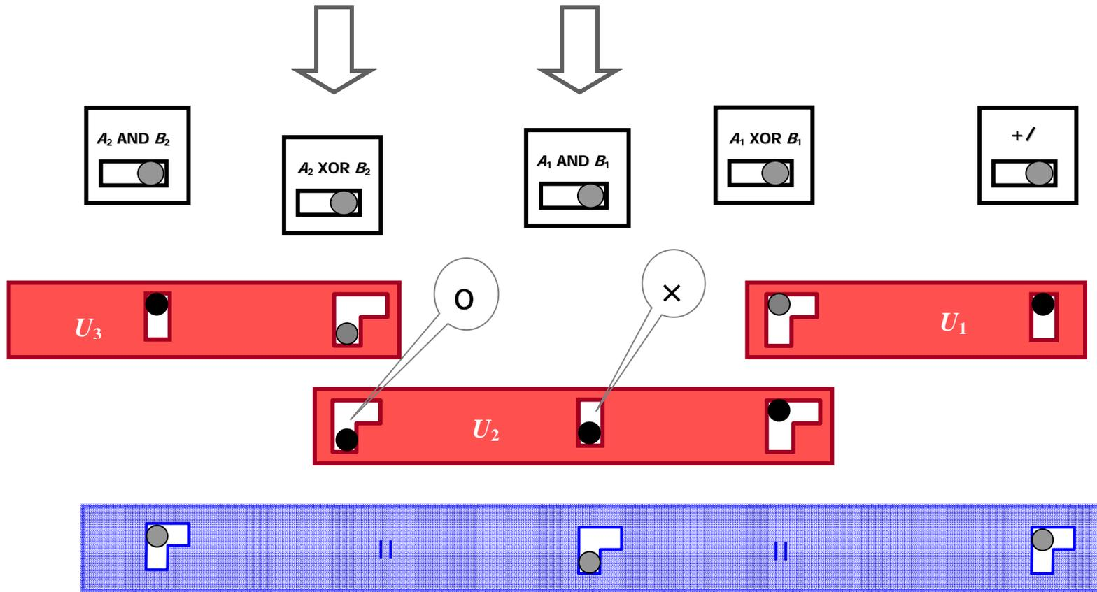
Takt I ist schon erfolgt. Der dadurch erreichte Zustand ist an den Positionen der Schaltstifte in den Verknüpfungsgliedern der Übertragsbleche  $U_1$ ,  $U_2$  und  $U_3$  abzulesen. Das übernächste Bild zeigt – in einem grafisch vereinfachten Explosionsbild – die dadurch hergestellten Kopplungsbeziehungen.
