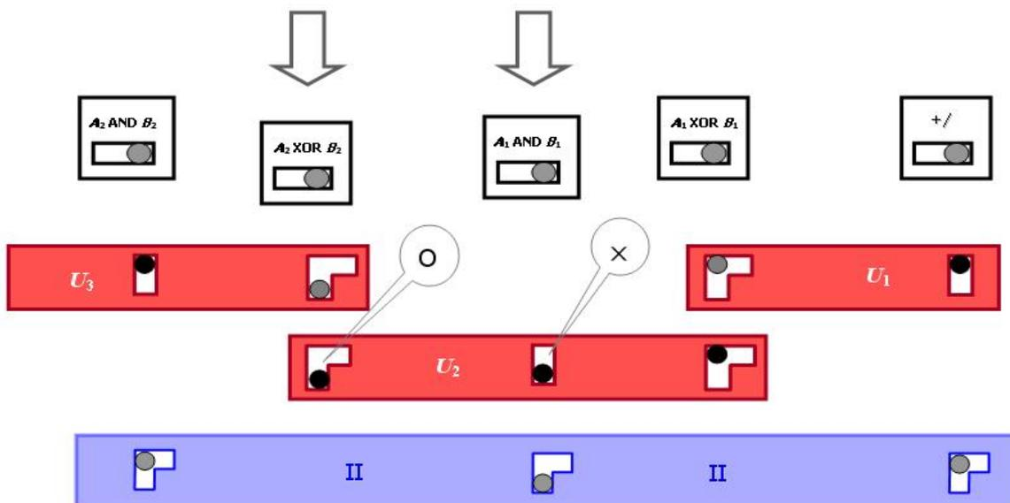
Takt I ist schon erfolgt. Der dadurch erreichte Zustand ist an den Positionen der Schaltstifte in den Verknüpfungsgliedern der Übertragsbleche  $U_1, U_2$  und  $U_3$  abzulesen. Das obige Bild zeigt – in einem grafisch vereinfachten Explosionsbild – die dadurch hergestellten Kopplungsbeziehungen zwischen den Übertragsblechen und dem Taktblech II.
