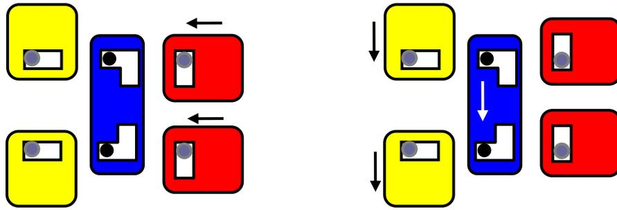
Das AND-Schaltglied liefert also genau das gewünschte Ergebnis: Nur dann, wenn beide Eingänge gleich 1 sind, wird durch den Takt auch der Ausgang auf 1 gesetzt.
