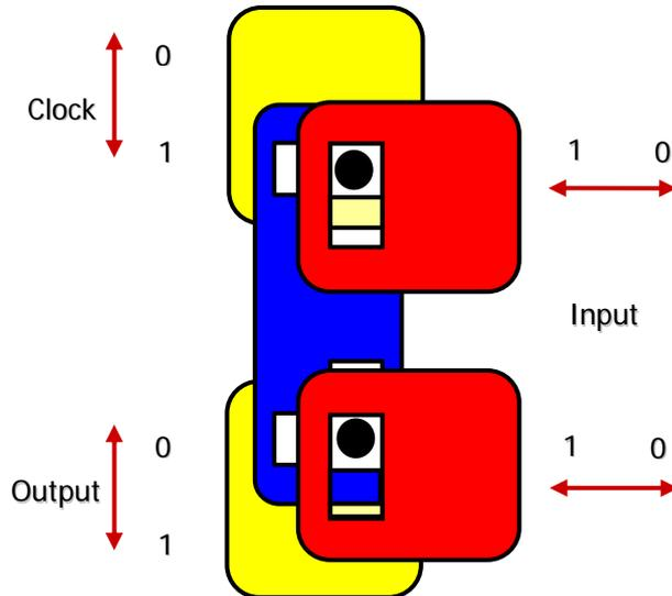
Die Ausfräsungen sind in den folgenden Explosionsbildern besser zu sehen. Im linken Bild sind Takt (Clock) und Eingangsgrößen (Input) jeweils in der Anfangsposition 0. Das rechte Bild zeigt das Ergebnis, wenn der Takt auf die 1-Position geschoben wird. Das Kopplungsblech und Ausgangsblech bewegen sich nicht.
