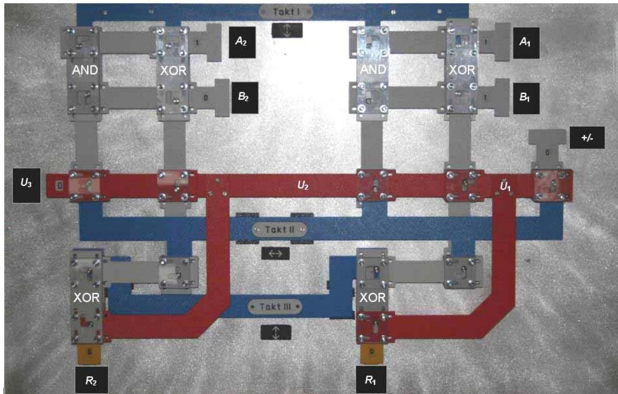
Wegen des zu erwartenden hohen Platzbedarfs eines Zahlenspeichers in Relais-technik entwickelte Zuse für seinen ersten Rechner eine mechanische Schaltglied-technik. Die Z1 baute er vollständig mechanisch auf. Der Z1-Addierer ist im Wesentlichen eine Eins-zu-eins-Übertragung der Relaislösung in eine von ihm eigens entwickelte mechanische Rechentechnik.
