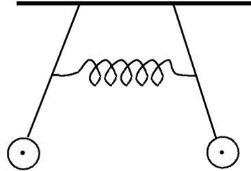
Beide Pendel schwingen mit gleicher Amplitude  $A$ , die Schwingung des einen Pendels ist gegenüber der Schwingung des anderen um  $\pi$  phasenverschoben. Man nennt solche Schwingungen, bei denen  $\phi_1 = -\phi_2$  ist, *antisymmetrisch*.
