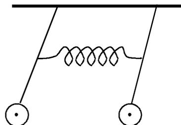
zustand nicht ändert. Frequenz und Schwingungsdauer entsprechen denen des Einzelpendels. Man spricht in diesem Fall von *symmetrischen Schwingungen*.
