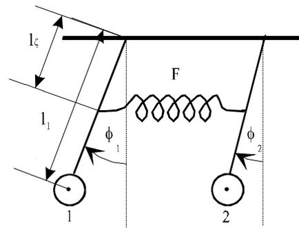
In der vorliegenden Anordnung ist die Feder deshalb etwas vorgespannt, die Pendel hängen in der Ruhelage schräg einander zugeneigt. In der folgenden Ableitung werden die Winkel  $\phi_1$  und  $\phi_2$  auf diese Ruhelage bezogen. Die Gesamtmomente, die auf die beiden Pendel wirken, sind
